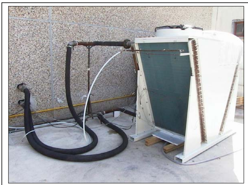
Fig.8 : Il banco prova outdoor utilizzato per la prima campagna di prove
