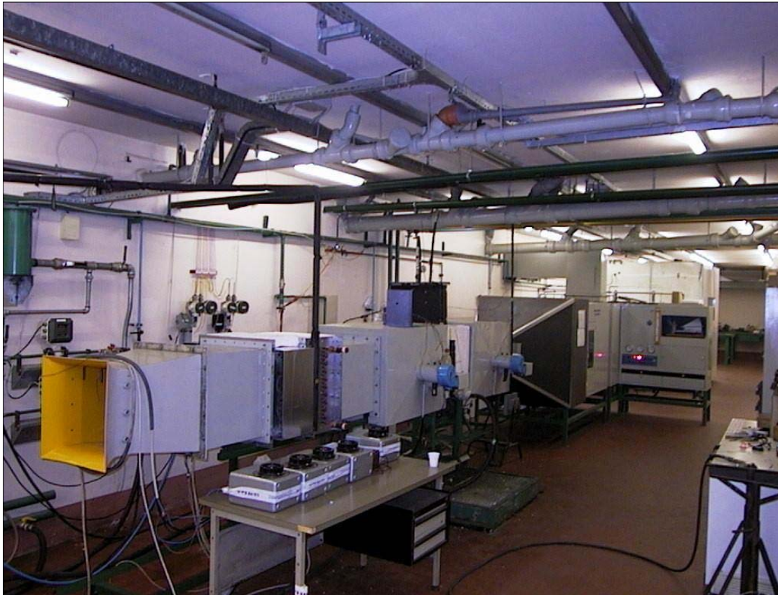
Fig. 7 Il tunnel aerodinamico come si presentava al termine delle modifiche apportate per la sperimentazione. Si notano: sulla sinistra, la sezione di riscaldamento dell'aria con Variac e quella di umidificazione tramite vapore; nella parte centrale dell'impianto, il "modulo di umidificazione".
